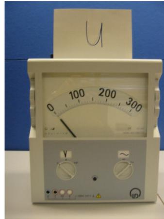
Abb. 6 Spannungs-Messgerät
