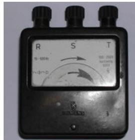
**Abb. 7** Drehfeld-Messgerät
