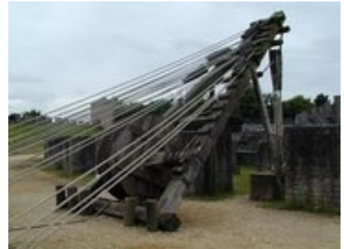
Römischer Baukran (Nachbildung)
