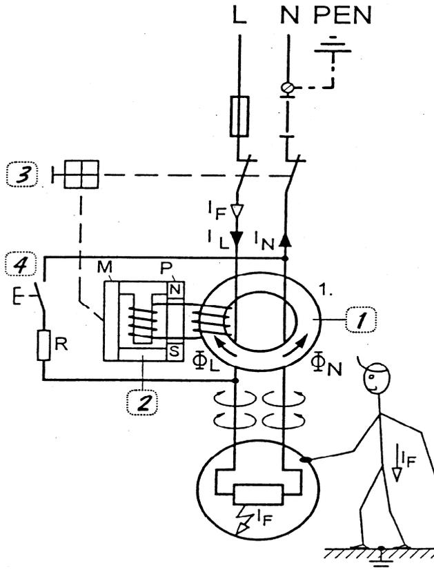
a) Bezeichnen Sie die Elemente des Fehlerstrom-Schutzschalters.
