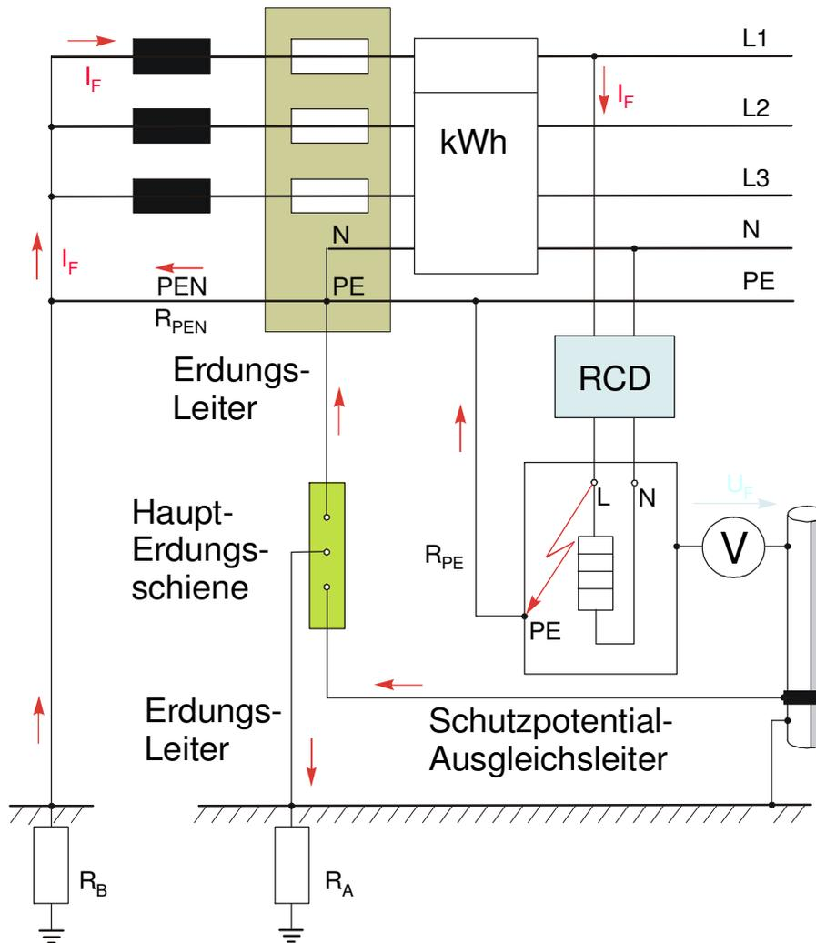
Ohmscher Leitungswiderstand vom Transformator bis zum Betriebsmittel
