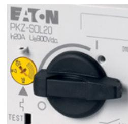
Ein thermischer Auslöser reagiert bereits beim 1,05 ... 1,3-fachen Strom und der magnetische Auslöser beim 6-fachen Strom.
