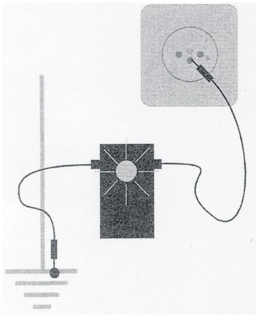
Diese Prüfung kann z. B. mit der im Bild dargestellten Prüftaschenlampe durchgeführt werden.
