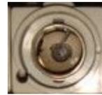
Die lose nicht genügend angezogene Schraubensicherung erwärmte sich, bei dauernd hohem Strom, so stark, dass der Porzellanwerkstoff zerstört wurde. Der Abbrand durch Funken ist deutlich an der noch vorhandenen Passschraube zu sehen.
