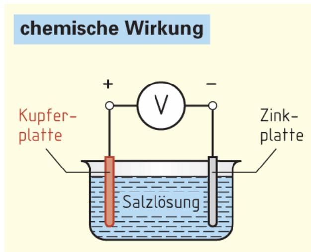
Ein galvanisches Element entsteht, wenn sich zwei unterschiedliche Metalle in einer leitenden Flüssigkeit (Elektrolyt) befinden
