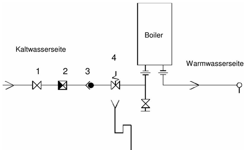
Das Sicherheitsventil ist das wichtigste bezüglich Schutz vor Überhitzung sprich gegen Überdruck. In Ihm wird der Überdruck abgebaut indem das Wasser auf eine Membrane drückt der eine Feder entgegenwirkt. Bei bestimmten Druckverhältnisse hebt die Membrane an und lässt Wasser entweichen. Um einen Rückfluss von Warmwasser in das kalte Trinkwasser zu vermeiden setzt man das Rückschlagventil ein.
