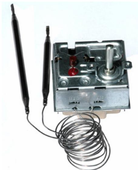
Der Thermostat mit Kapillarrohrfühler funktioniert mit dem Prinzip der Volumenausdehnung einer Ausdehnungsflüssigkeit, welche sich bei Erhöhung der Temperatur ausdehnt und durch die in Kapitaler verbundene Membrandose einen Hub verursacht. Dieser wird auf das Schaltwerk übertragen. Bei einem bestimmten Hub, d.h. wenn die Fühlertemperatur den eingestellten Soll-Wert erreicht, kippt der Kipphebel und öffnet die Schaltkontakte schlagartig.
