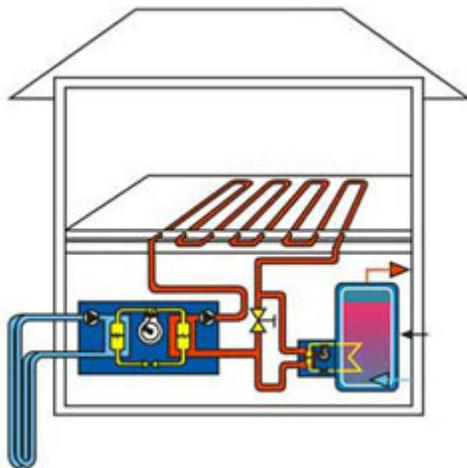
Wenn die Warmwasseraufbereitung an das Heizsystem angeschlossen wird, so wird die Wärmeenergie über einen sogenannten Wärmetauscher übertragen. Die beiden Systeme Warmwasser und Heizungskreislauf sind somit nicht mit einander verbunden, in ihm wird lediglich die Wärme übertragen.
