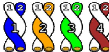
Twisted-Pair-Kabel enthalten Adernpaare aus je zwei miteinander verdrehten (engl. twisted) Paaren (engl. pair) von Einzeladern.
