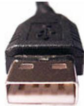
USB-Stecker Typ A. Deutlich zu erkennen sind die voreilenden äußeren Pins für die Versorgungsspannung.
